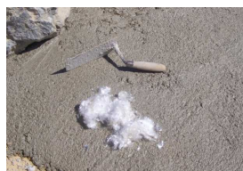
Hormigón con fibras de PP que reducen las retracciones, mejoran la resistencia al impacto
