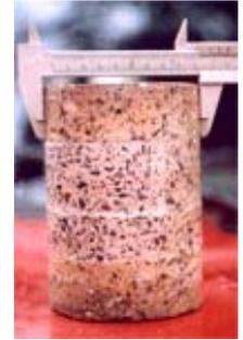
UNE-EN 12504-1:2009. Ensayos de hormigón en estructuras. Testigos. Extracción, examen y ensayo a compresión.
