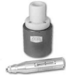
Norma UNE-EN 12504-2:2002. Ensayos no destructivos. Determinación del índice de rebote
