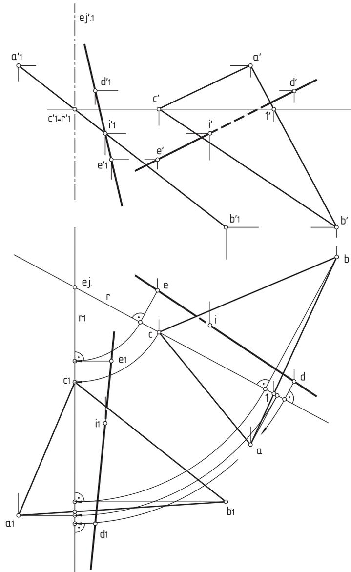
1. Mediante giros, hallar la recta que siendo perpendicular a la recta R, para por el punto A y corta a R. Comparar el resultado con el obtenido en la hoja de ejercicios 7.9.
